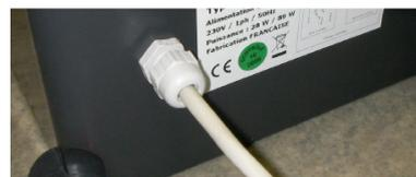
4. Apriete el prensaestopas para fijar el cable de alimentación.
