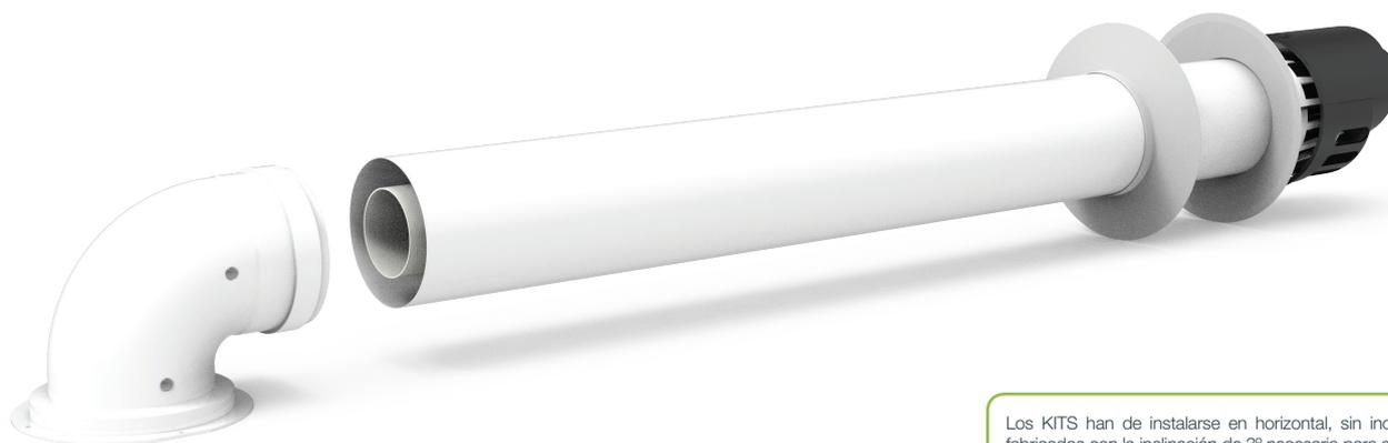
Los KITS han de instalarse en horizontal, sin inclinación. Están fabricados con la inclinación de 3° necesaria para su instalación.
